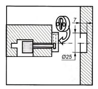
5. На столбе установите и закрепите саморезами замочную часть.
