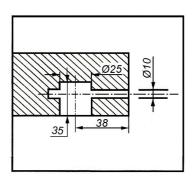
2. Сделайте разметку и просверлите отверстие Ø25 мм и глубиной 35 мм в нижней части поручня.
