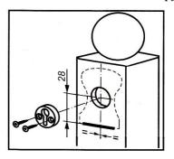
4. Разметьте и просверлите в столбе на высоте 28 мм от нижней отметки отверстие Ø25 мм и глубиной 7 мм для замочной части стяжки.
