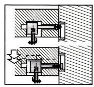
6. Закрутите стяжку таким образом, чтобы шпилька скрылась в поручне. Для скручивания стяжки используется торцевой шестигранный ключ 5 мм. Затем подведите поручень к столбу и выкручивайте стяжку таким образом, чтобы шпилька попала в отверстие замочной стяжки. Затем отпустите поручень вниз и затяните стяжку.
