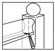
3. Отметьте требуемое положение поручня на столбе по нижней границе и по вертикальной оси.
