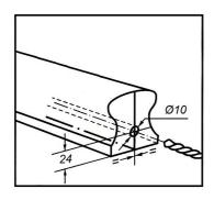
1. Сделайте разметку на торце поручня и просверлите отверстие Ø10 мм и глубиной 60 мм.
